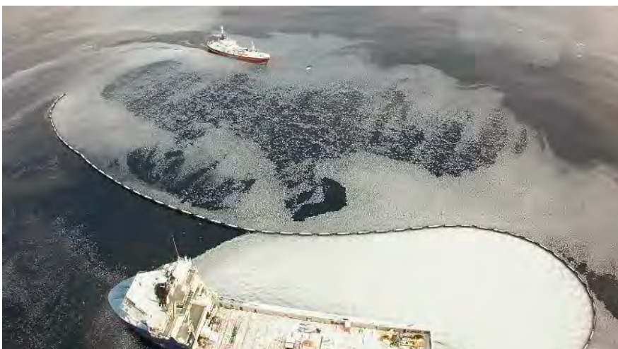
Figur 2-8 Bilde tatt fra aerostat som viser uttestingen av Ro-Boom 3200 fra Troms Arcticus nordøst for Bjørnøya, på ca. 75° nord, 22° øst. Foto: NOFO
