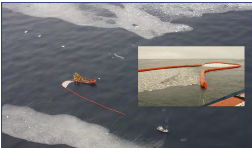
Figur 2-5 Testing av Norlense 1200 lense og overløpsskimmer fra FRAMO i is Nord-øst av Bjørnøya på ca. 76 ° nord, 20 ° øst, 610 km fra Hammerfest. Foto: NOFO
