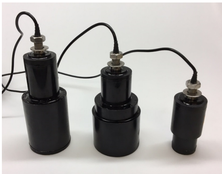
Figur 5 Ultralydtransducere brukt i eksperiment. Fra venstre: BII-7509 (9,3 kHz), BII-7502 (21 kHz), BII-7506 (54 kHz)
