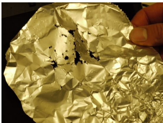
Figur 4 Aluminiumsfolie perforert av kavitasjonseffekter
