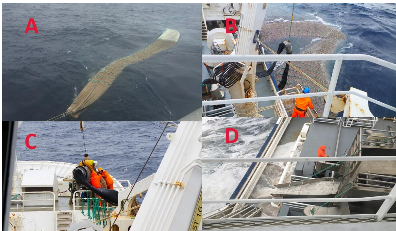
Figur 3. Inntaking av fangst. A: Trålsekken løsnes og føres frem langs styrbord side, B og C: Enden av trålsekken sys på fiskepumpen, D: Fangsten går over en silkasse og fordeles i tankene seksjon for seksjon.
