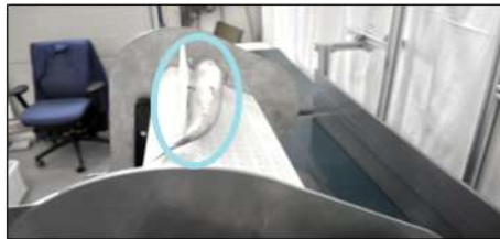
5. Medbringer drar fisken over toppen av stigebåndet og ned på transportør.
