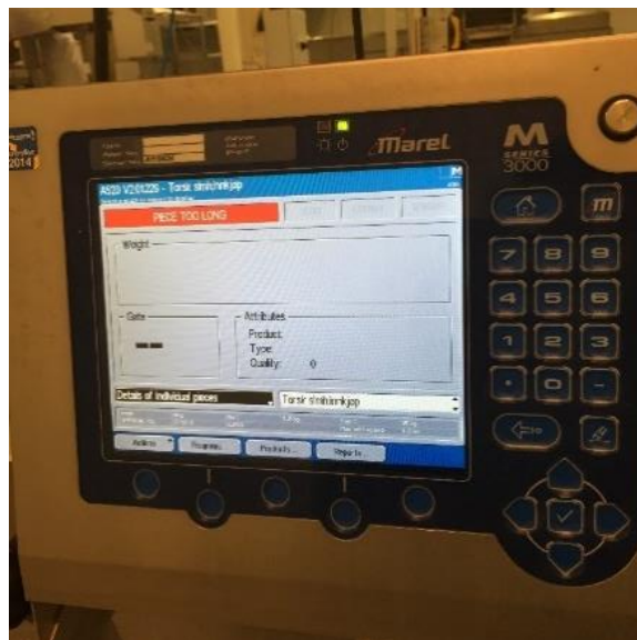
Figur 4 Display fra grader som viser vekt og lengde på hver fisk, skjermbildet viser når en fisk er for lang (over 120 cm) og derfor går ut i kar for manuell veiing
