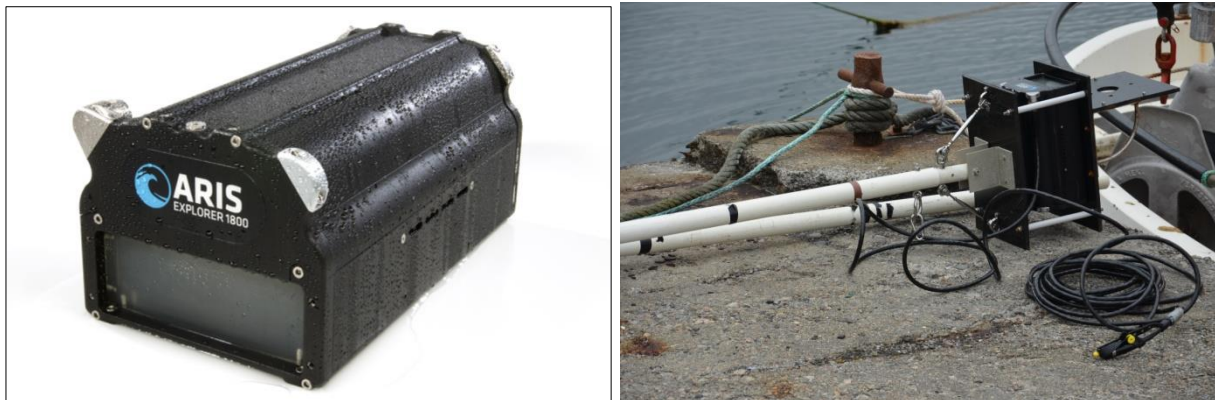
Figur 6. Aris-sonaren som ble benyttet i 2017-forsøkene. Bildet til høyre viser hvordan sonaren var montert på et metallrør som under observasjonene var festet til styrbord side av sjarken.
