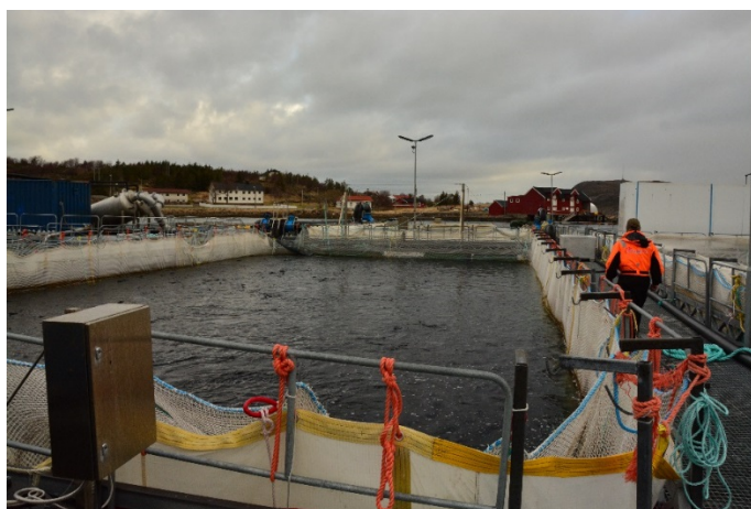
Figur 2 – Lukket ventemerd #6 like før uttak av kontrollfisk før trengoperasjonen startet. Fisken (117 500 kg) hadde stått uforstyrret ved 5,8°C i merden i tre dager etter levering med brønnbåt. Fisketettheten var 68 kg/m 3 .
