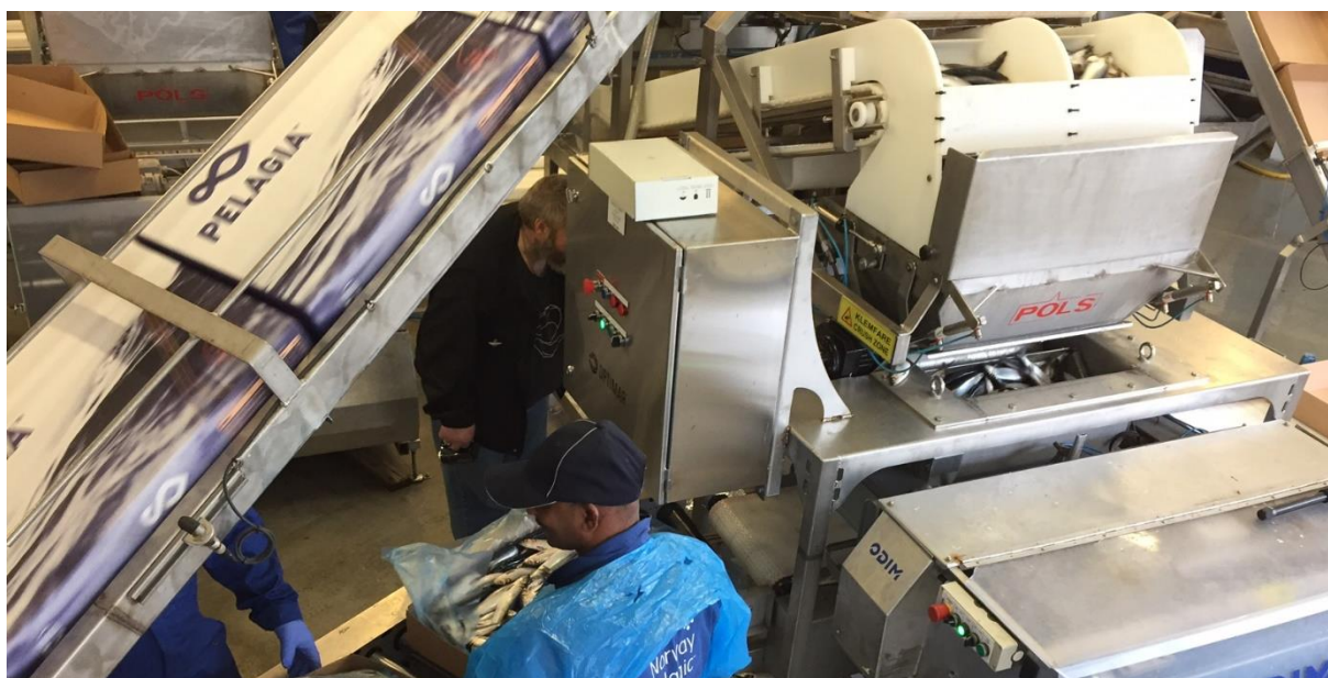
Prototypen på ensretteren står plassert under polsvekten på pakkelinje 1 i Liavågen
