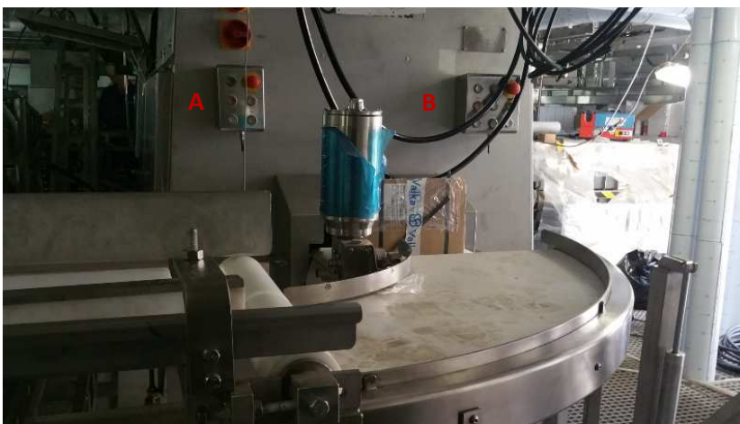
Bilde 8. Innmatingsbånd. Kontrollboks for kompressor (A) og Valka kutteren (B).
