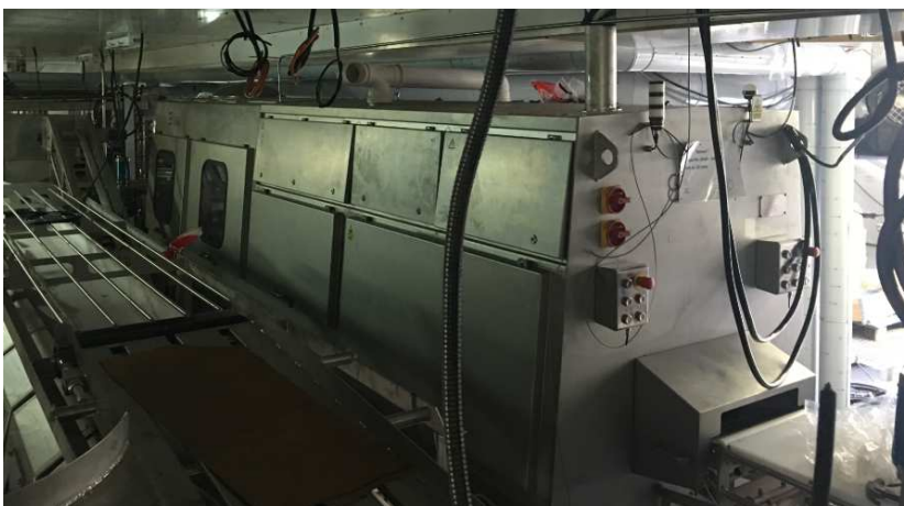
Bilde 5. Valka kuttere ble laget ekstra kompakt for å få plass i produksjonslinjen.
