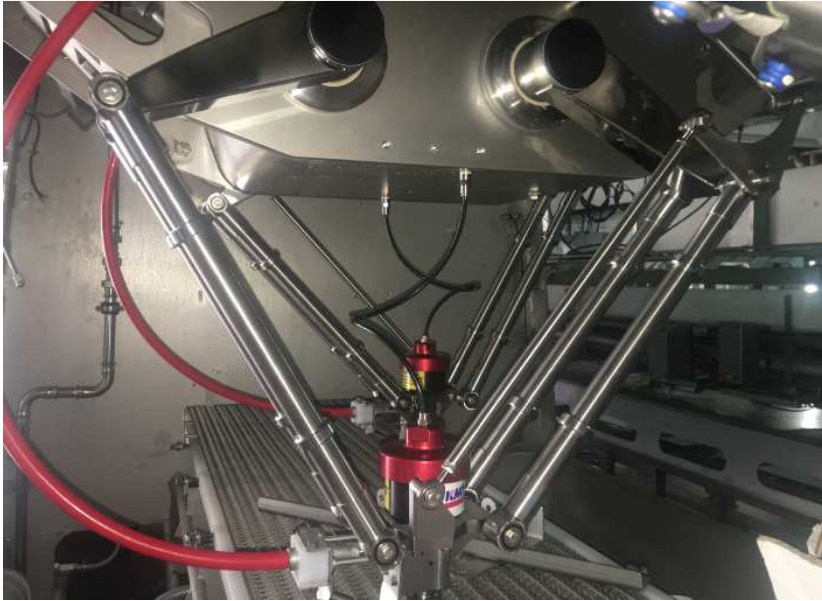
Bilde 3. Plassering av Delta 2 roboter inne i maskinen.
