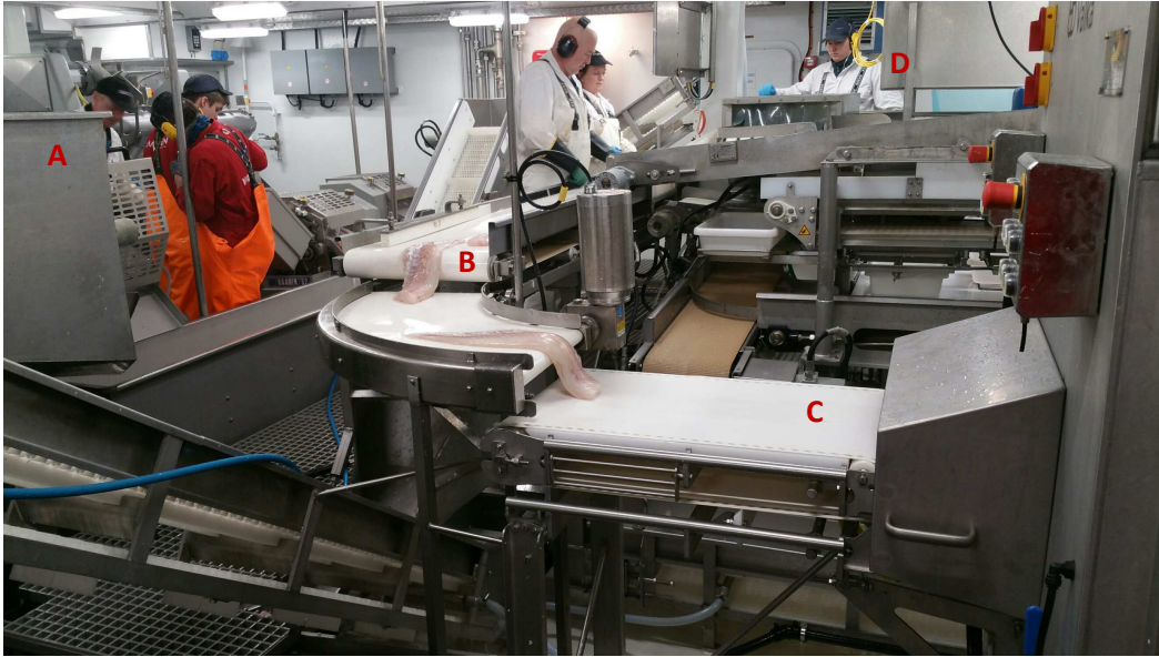
Bilde 9. Oversikt over prosesslinja tilknyttet Valka kutteren. A: Filetmaskin, B: Trimdebord, C: Immating, D: Pakkestasjon.
