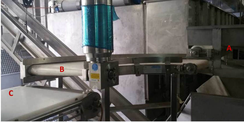
Bilde 6. Oversikt over transportbånd. Trimmebånd (A) spesialdesignet 90 graders bånd (B), og innmatingsbånd (C).
