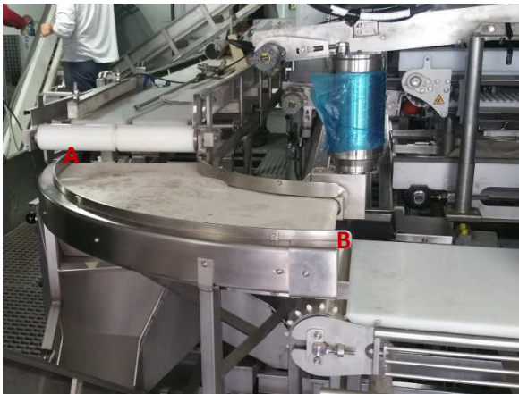
Bilde 7. Transportbåndene sett fra en annen vinkel. Trimmebånd (A) spesialdesignet 90 graders bånd (B), og innmatingsbånd (C).
