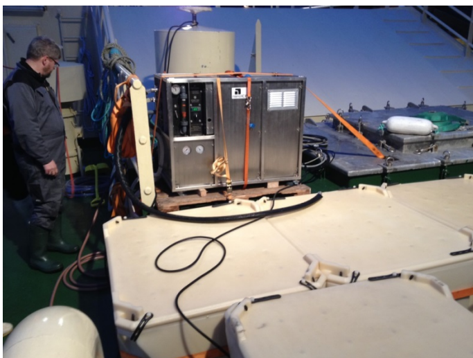
Bilde 1: Nanoice maskinen installert ombord.
