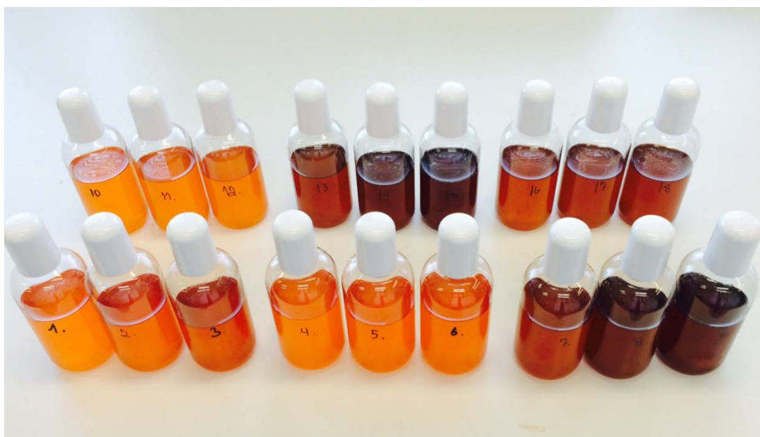
Figur 2: Utsentrifugert olje til analyse av FFA, PV og AV. Flaske 1, 2 og 3 er fra ukonservert råstoff inkubert ved hhv 4, 8 og 12 °C. Tilsvarende er flaske 4, 5, 6 konservert med sulfitt, flaske 7, 8, 9 med eddik, flaske 10, 11, 12 med eddik+sulfitt, flaske 13, 14, 15 med eddik+Vitalox og flaske 16, 17, 18 med eddik+CO 2 .
