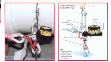
Korrekt montering af hydrostatisk udløser til redningsflåde
