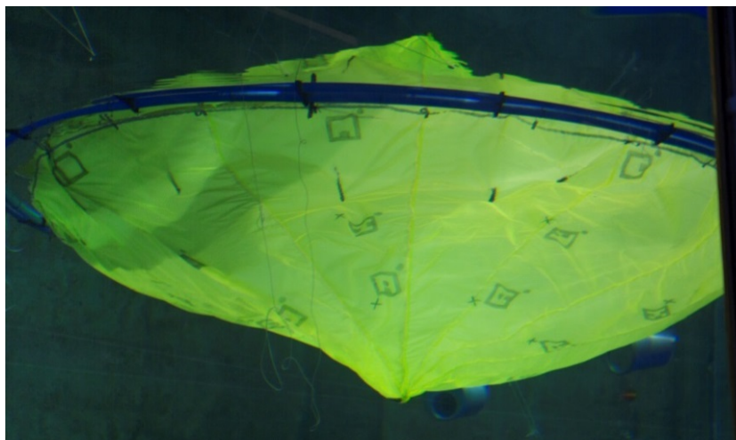
Figur 12. Kinahatt satt ved 8,2 cm/s strøm før reduksjon. Selv etter reduksjonen ble ikke duken helt fylt.
