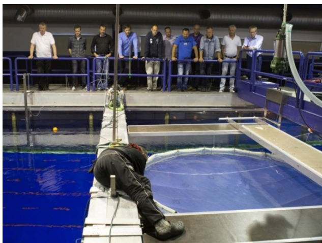
Figur 2. Utsetting av modellskala av merd og duker med ulike design i flumetanken i Hirtshals.
