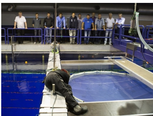
Figur 1: Utsetting av modellskala av merd og duker med ulike design i flumetanken i Hirtshals.
