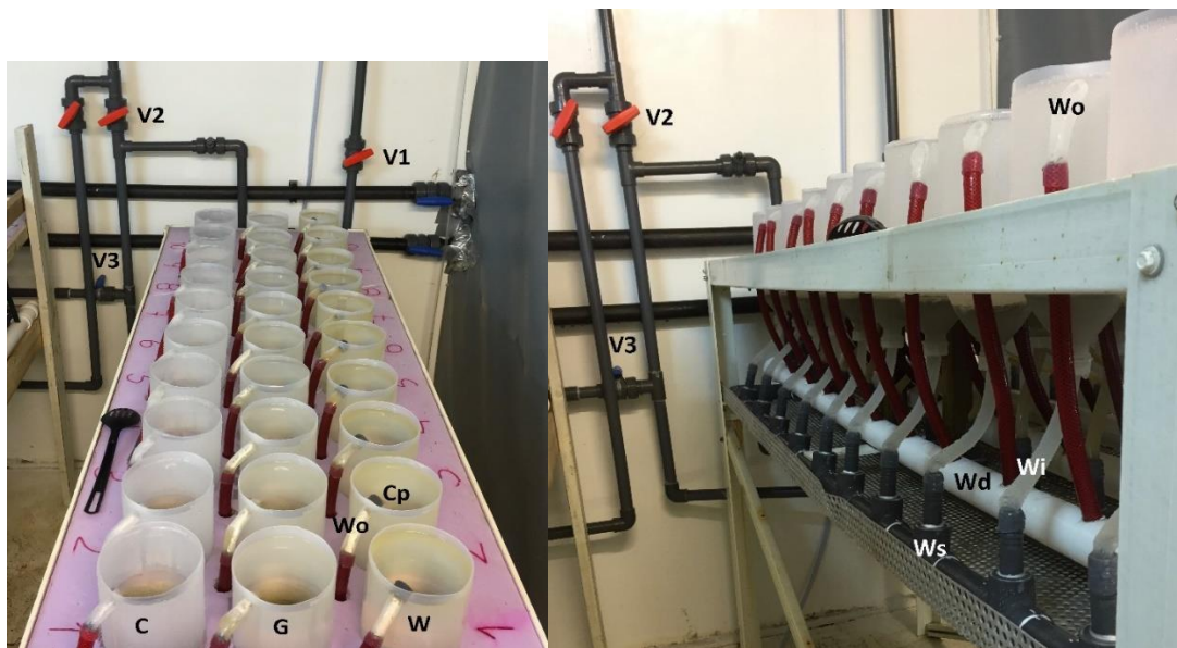
Figur 30: Oversikt over forsøksrigg. C: Kald temperatur, G: Gradient og W: varm temperatur.
