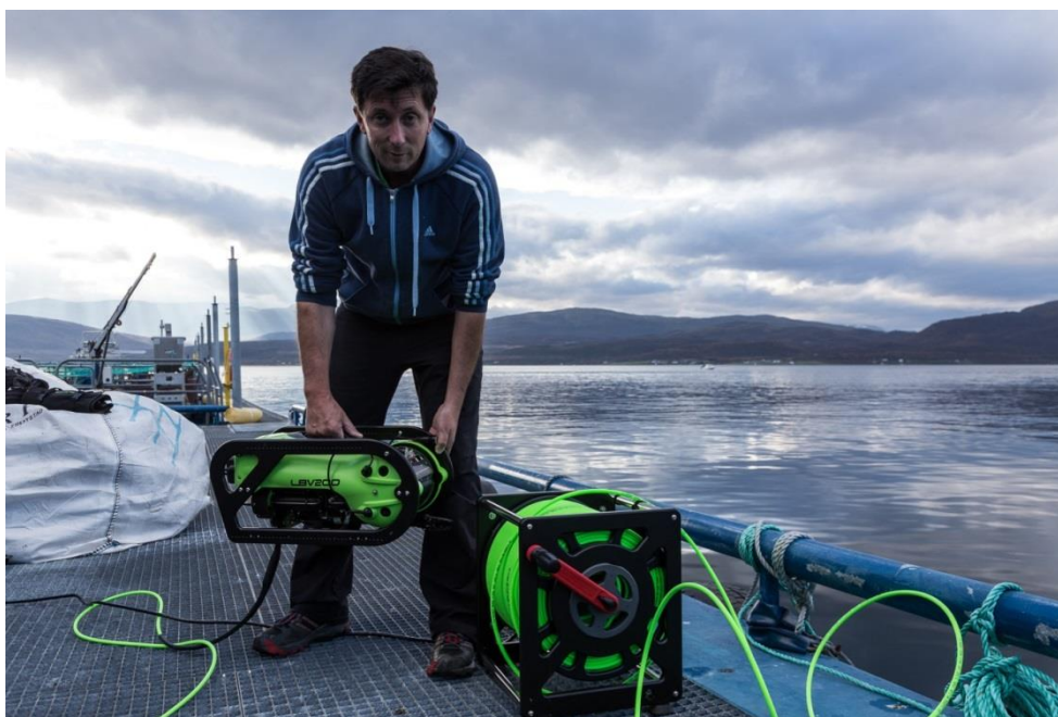
Figur 12 Nofimas ROV som likner de brukt i lakseoppdrettsnæringen. Slike kan brukes til raskt og relativt billig å finne områder med høy tetthet av kråkeboller.
