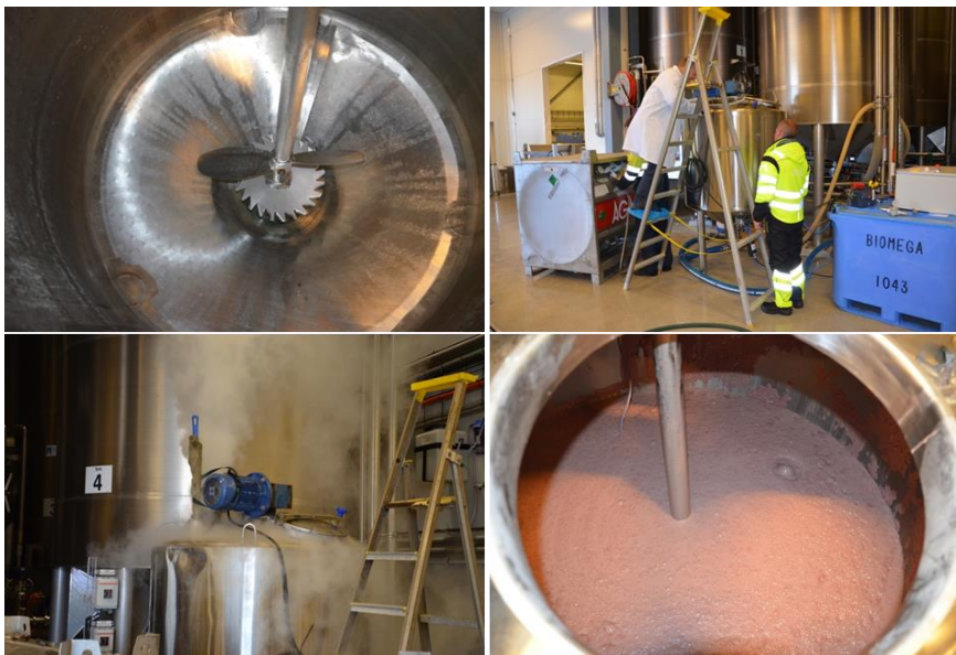
Figur 1. Nedkjøling av innmat med CO 2 og N 2 ved BIOMEGA 31. mars 2014.
