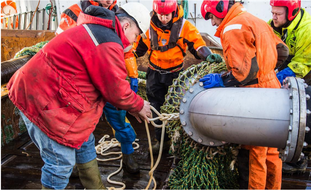
Figur 20 Festing av codend til pumpeslangen (Foto: © NOFIMA)
