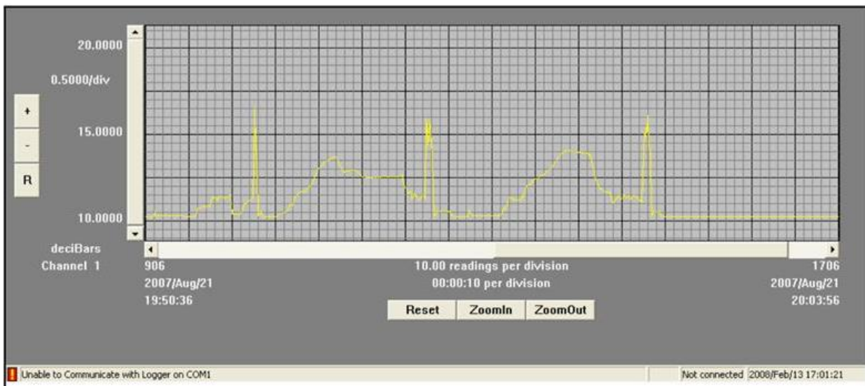
Figur 3 Figuren viser trykkprofilene til skovelpumpen som er noe "uryddig". I tillegg blir en viss andel av fisken skadet i prosessen av impellerbladene (Midling et al. , 2008).
