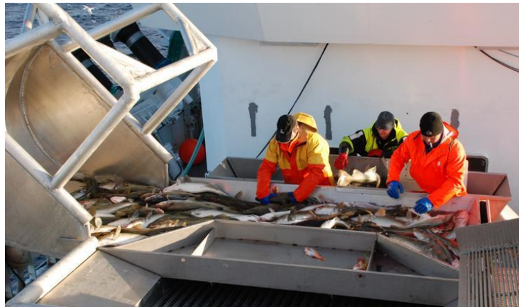
Figur 14 Fisk tømmes i vannfylt vugge, og helles inn på sorteringsbord for sortering og telling (Isaksen & Midling, 2012)
