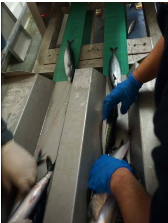
Figur 13: Manuell innmating av makrell.
