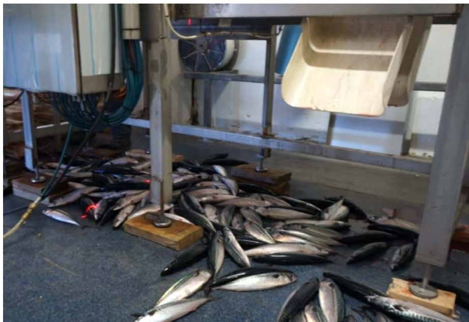
Figur 18: Fisk som ramlet av transportbåndet under kapasitetstesten.
