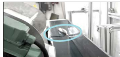
6. Fisken transporteres forbi 3D-skanning ved glippen mellom transportører.
