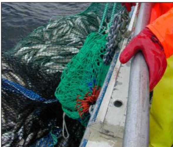
Bilde 24: Kjettingvekt krøkes fast i sekkeløftet 3–4 masker foran codlina. Under utsetting trekkes løft med kjettingvekt til side og slippes ved siden av snurrevadsekk for å hindre vase.
