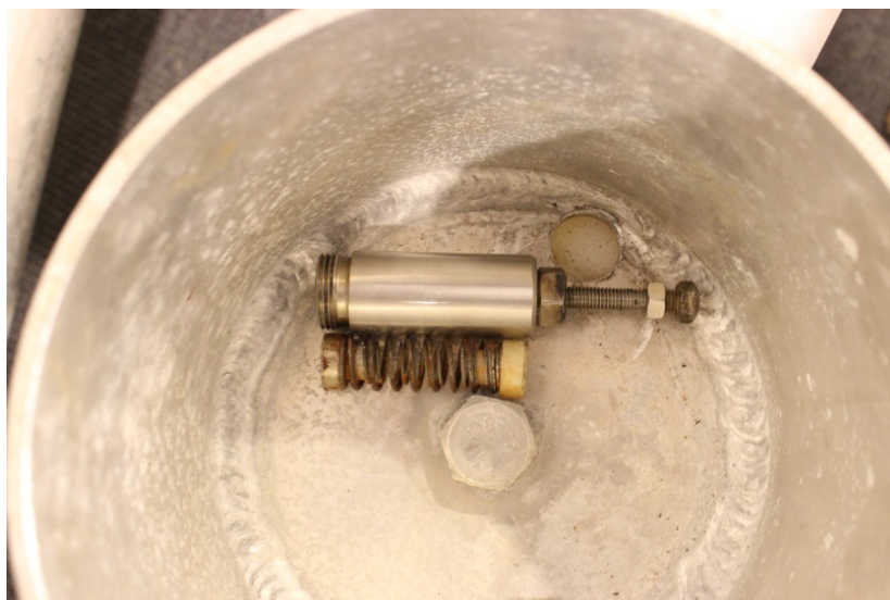
Bilde 17. Justerbar brems i deler. Den hvite plasten i enden av fjæra ligger mot plasten i hullet, fjæra ligger inni stålsylindren. Bremsen skrues til ved å justere skruen og dermed hvor mye motstand en ønsker å oppnå (Foto: Vollstad 2014).
