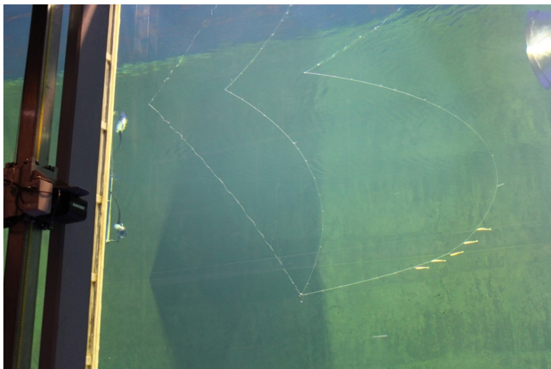
Bilde 23. Fasongen på dorga ved 3 knop og dybde/lengde forhold 1:4 med 5 stk. 10 kilos fisk bak i bukta (Foto: Vollstad 2014).
