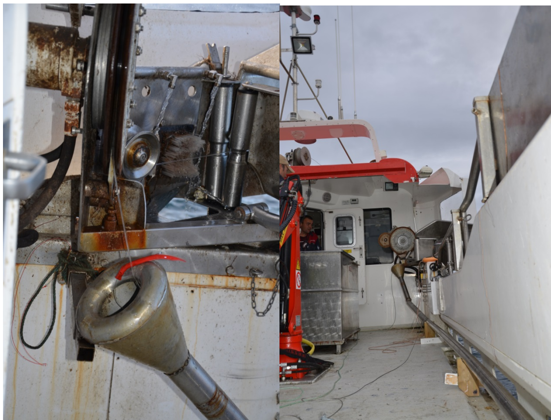
Bilde 25. Bilde fra dekk på "Ørntind" som viser 2,5 mm part med makkangler nr. 10 . Parten går rett fra kveileren, inn trakten, gjennom røret som ligger på styrbord side og ut bakpå hekken (Foto: Nordheim 2013).
