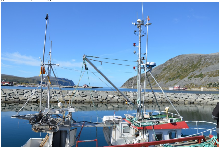
Bilde 18. Dersom bommen bygges om kan hele riggen løftes opp fra dekket og bommen svinges frem til styrbord stag på rorhuset. Det må lages en krybbe ved staget som bommen er låst i under fiske (Foto: Vollstad 2014).
