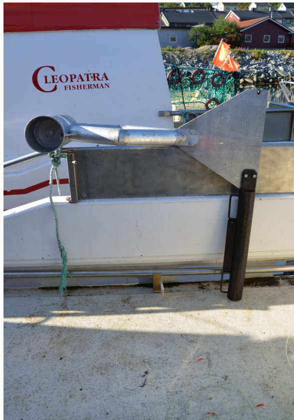
Bilde 3. Gjennomføring med lodd og base (trekant) sett fra siden. Lodd og gjennomføring er stivet av mot basen (aluminiumstrekanten) slik at gjennomføringen hele tiden står vannrett i havet (Foto: Nordheim 2013).
