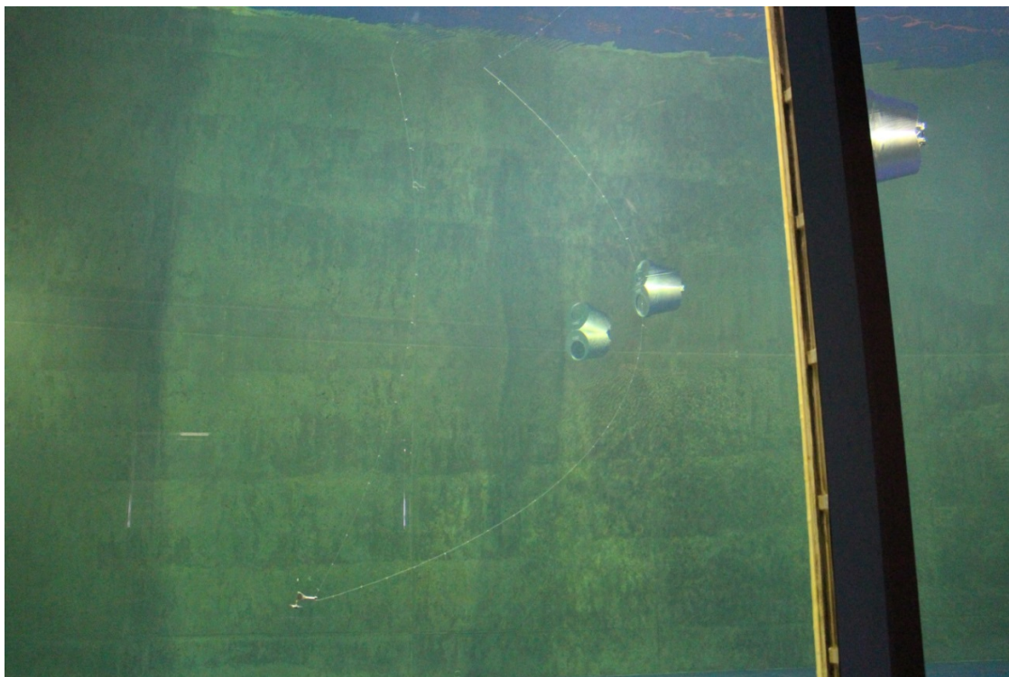
Bilde 9. Fart 1 knop og dybde/lengde forhold 1:3. Bukten bak gjennomføringen er svært kort og den ønskede fiskebukten er nesten helt fraværende (Foto: Nordheim 2014).
