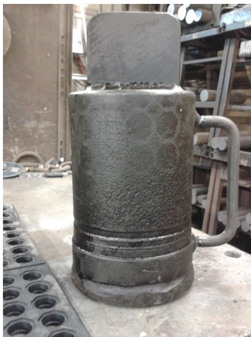
Bilde 19. Kort og tykt lodd (vekt 50 kg, lengde 40 cm) som ble brukt under Tokt 3 og viste seg å være mer brukervennlig enn det på 50 kg og lengde 93 cm (Foto: Nordheim 2014).
