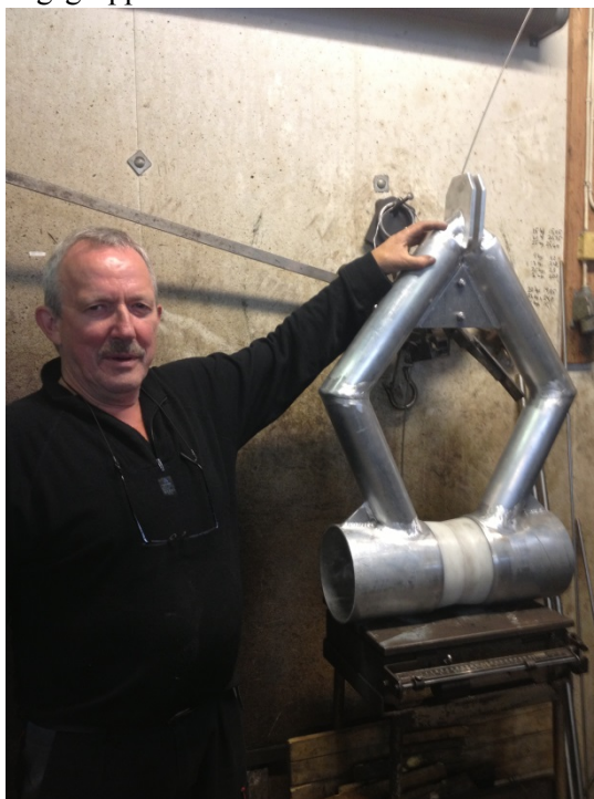
Bilde 5. Gunnvald Nordheim daglig leder ved Hillesøy Mekaniske Verksted med den første gjennomføringen i aluminium med justerbar brems som verkstedet prosjekterte og lagde vinteren 2013 (Foto: Nordheim 2013).
