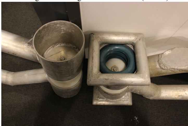
Bilde 14. Formen på endestykkene på gjennomføringen er endret fra firkantet (til høyre) til rund (til venstre) (Foto: Vollstad 2014).
