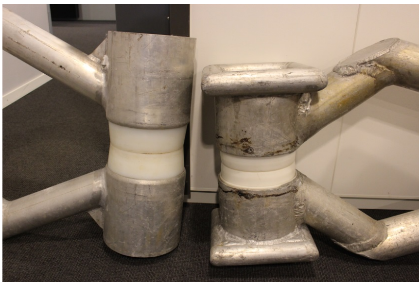
Bilde 15. Bremsen er gjort bredere og dermed er også totalbredden bredere (Foto: Vollstad 2014).
