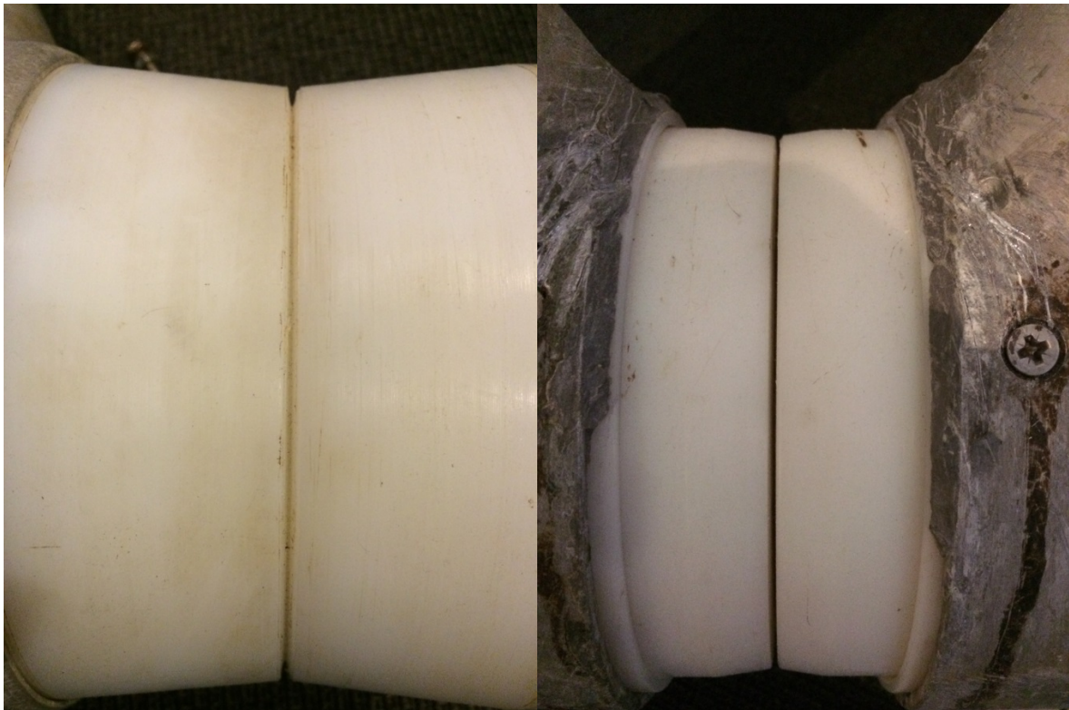
Bilde 6. Selve bremsesystemet med spor hvor parten skal gå. Til høyre den originale bremsen til Brinchmann som er todelt og til venstre den første gjennomføringen i aluminium som Hillesøy Mekaniske Verksted AS laget. Denne er i ett stykke og beregnet på tykkelser på parten fra 1.6-3.0 mm (Foto: Vollstad 2014).
