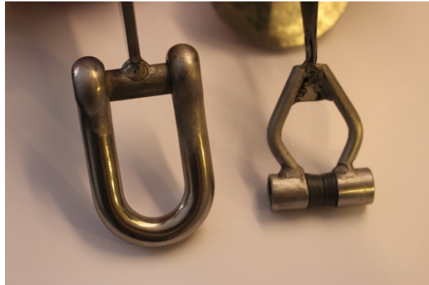
Bilde 11. Nedskalert gjennomføring med brems til høyre, og en glatt syrefast gjennomføring til venstre (Foto: Vollstad 2014).
