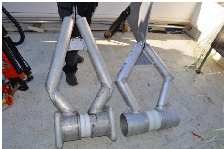
Bilde 4. Den originale gjennomføringen til Sunvald Brinchmann til venstre og den nye gjennomføringen med justerbar brems til høyre. Gjennomføringsprinsippet er likt, men det er foretatt noen små endringer som bildet viser (Foto: Nordheim 2013).
