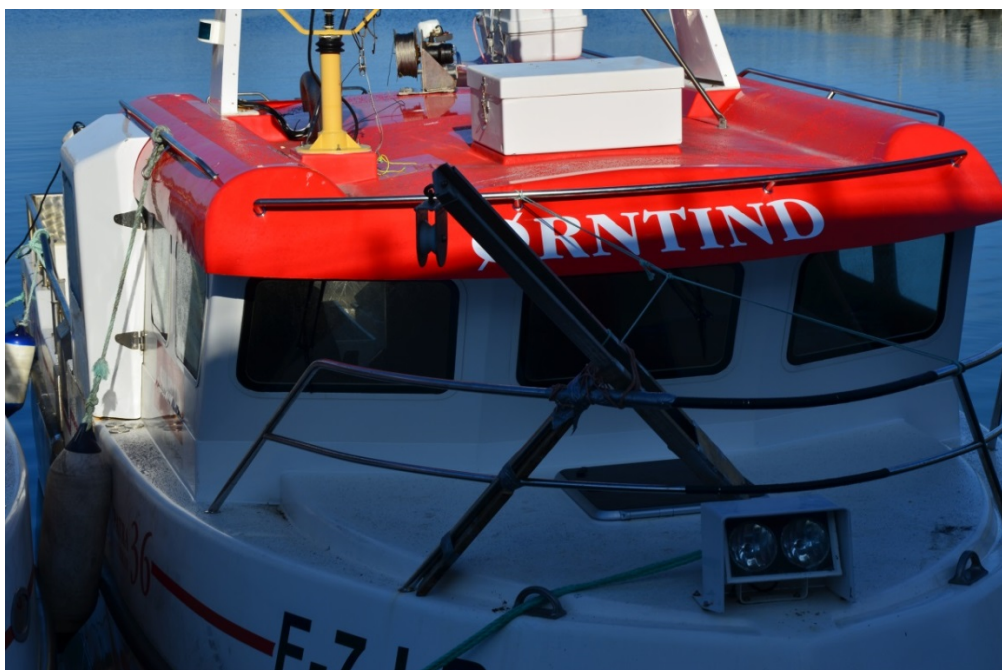
Bilde 8. "Ørntind" med wiretrommel på rorhustaket (til høyre for gul lyskaster-fot på bildet). Wiren går gjennom trinsen på utliggeren fremme på baugen og ned til riggen (Foto: Nordheim 2013).
