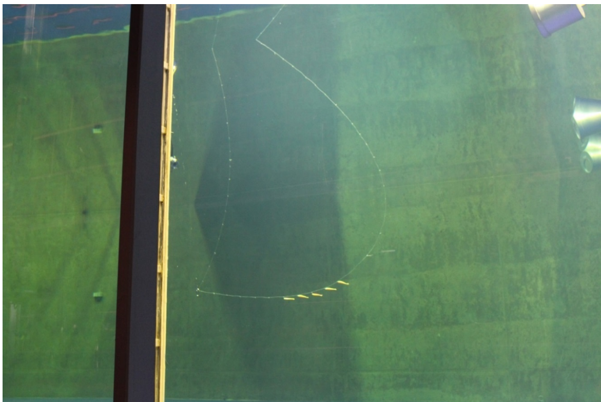
Bilde 21. Fasongen på dorga ved 1 knop og dybde/lengde forhold 1:4 med 5 stk. 10 kilos fisk bak i bukta (Foto: Vollstad 2014).
