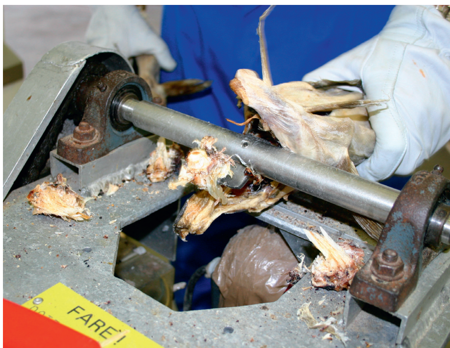
En «nakkekutter» benyttes til åpning av nakken på tørrfisken. De fremste nakkevirlene rives ut av tørrfisken og åpner for bedre ettertørking.
