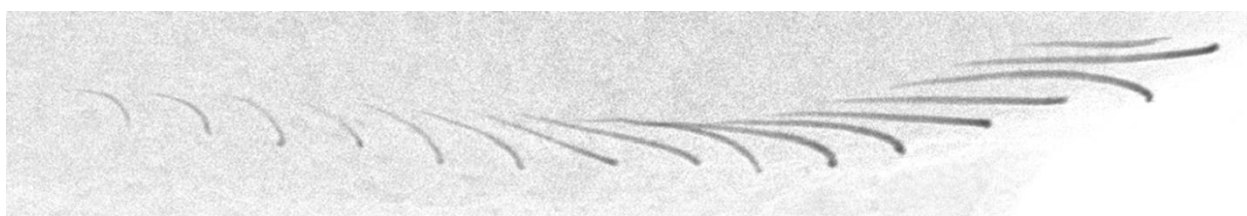
Figur 25. Detaljbilde av pinnebeinrekka sett med røntgen, ved bruk av skråstilling mellom fileten og røntgenkilde og -sensor.
