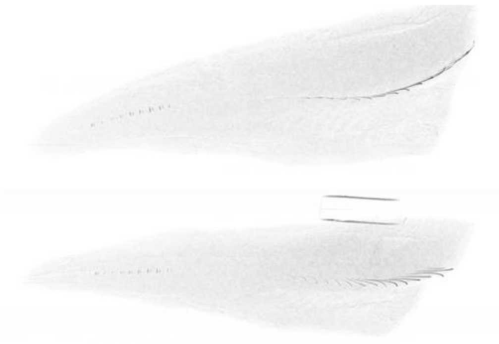
Figur 24. Prosessert røntgenbilde med fileten liggende flatt (øverst) og skråstilt (nederst) i forhold til røntgenkilde og -sensor.
