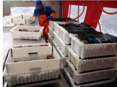
Figur 3.4.5 - Kasser med hull i bunn nyttet til vanngjennomstrømming. Sjøvannsslange koblet til en forsyningsstokk.
