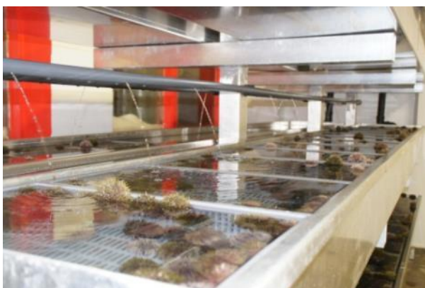
Figur 3.5.2 – Eksempel på landbasert system for levendelagring av kråkeboller
