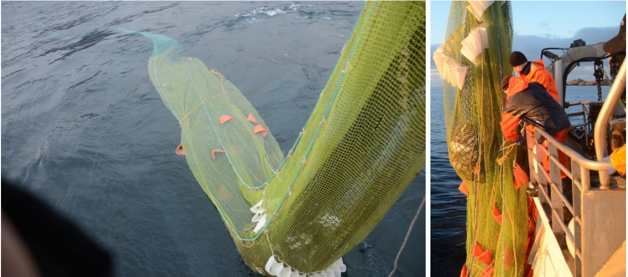
Figur 3. For seleksjon ble det brukt småmasket dekknett for å samle fisk som gikk igjennom maskene på sekken. Dekknettet ble utspilt med bruk av kites (hvite og oransje).
