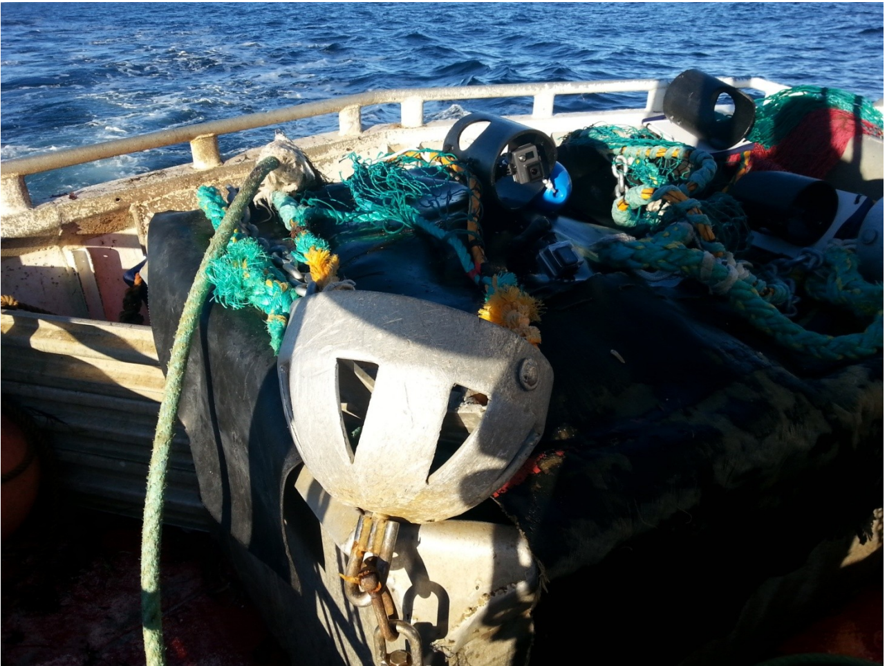
Figur 12: Med halvkuler i aluminium som borte snurret snurrevadvingene seg.
