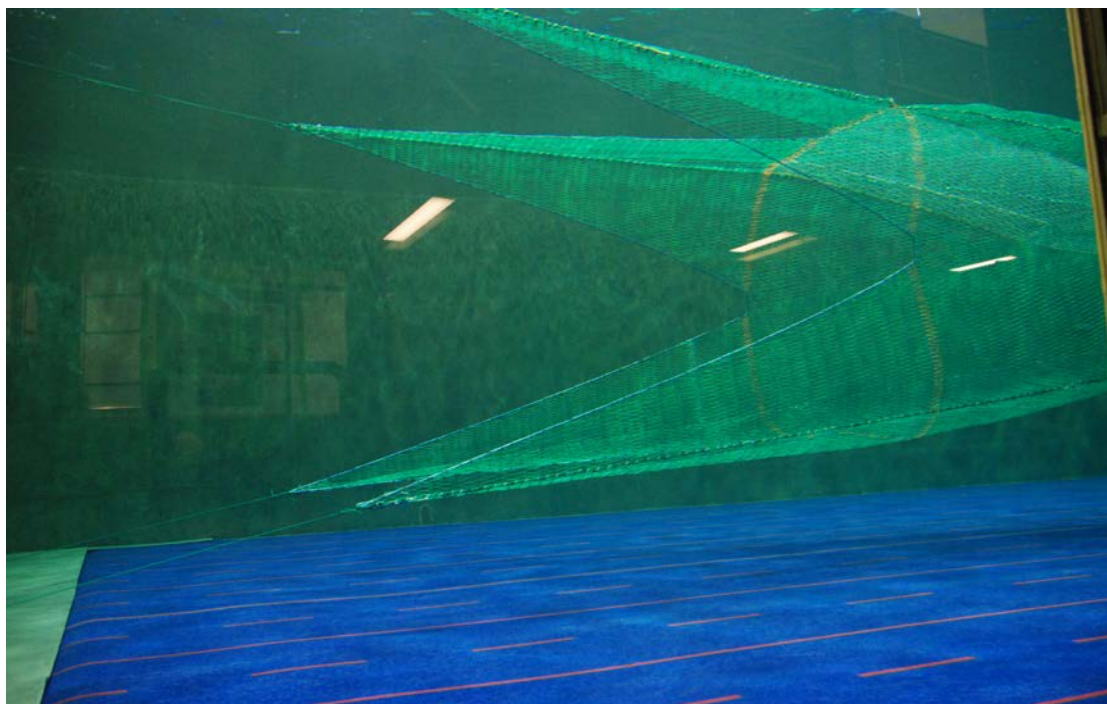
Bilde 1. Forpart av forlengelse med vingspisser som tauepunkt. Merk forkant av ledepanel som er montert tvers over overpanelet.
