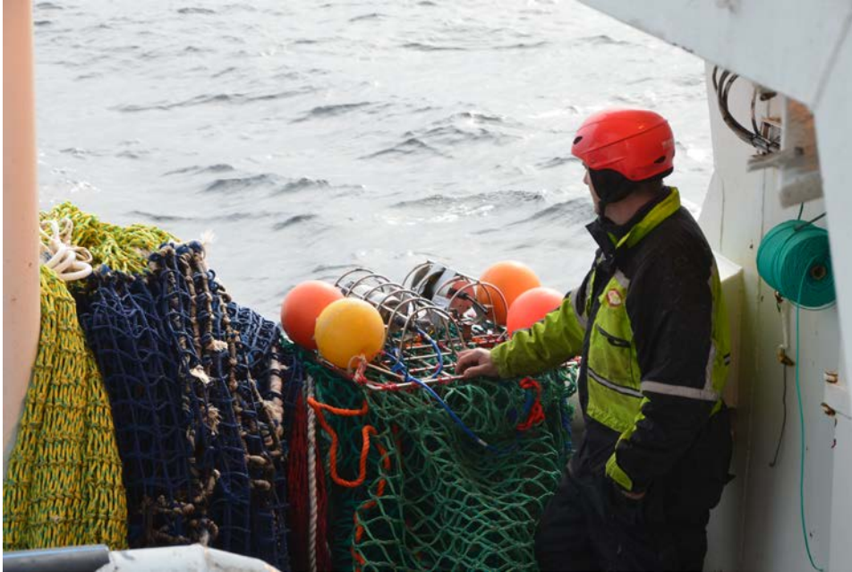
Bilde 7. Kamerautstyr sydd fast på forlengelse rett foran fangstutslipp. Kvadratmaskepose (blå) klargjort for setting. Styrbord tau settes ut, det er like før nota settes.
