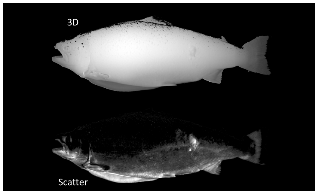
Figur 5-16; 3D-bilde øverst og et spredningsbilde som viser en tydelig kontrast i sår på overflaten av laksen.
