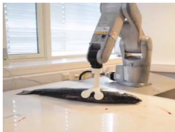
Figur 5-6; Denso-robot, griper og en laks på glatt overflate.
