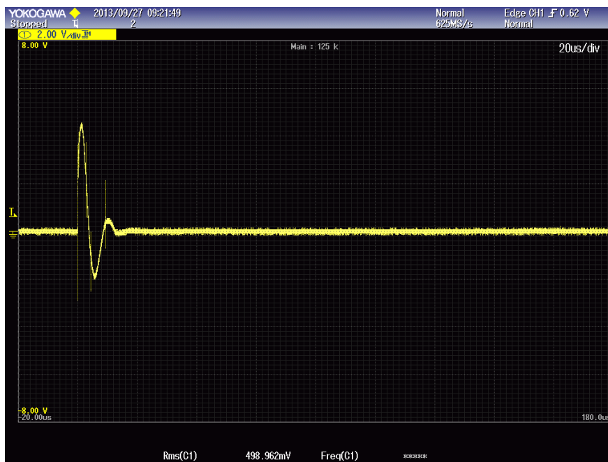
Figur 5: Strømforløp i motstanden på 500 \Omega ved innsetting av en seriemotstand på 4,7 \Omega i jordledningen til stålhansken
