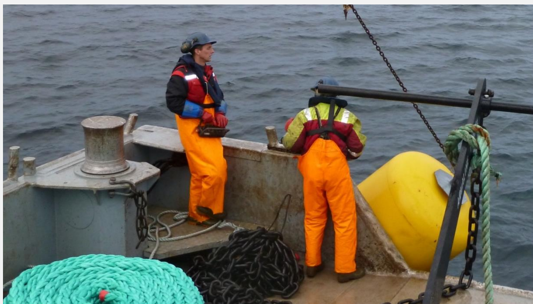
Figur 11. Kran fjernstyres med håndholdt kontrollenhet i forbindelse med utsett av fortøyning til et oppdrettsanlegg (foto: Halvard Aasjord, SINTEF).
