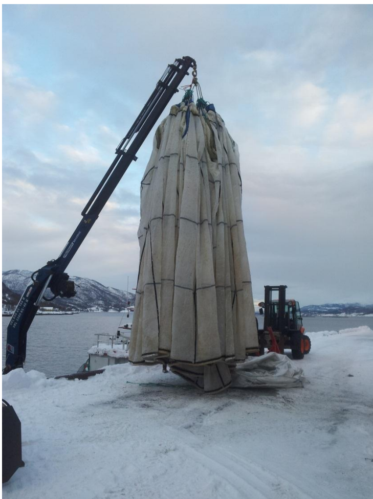
Figur 2: Skjørt opphengt i kran for tørking.
