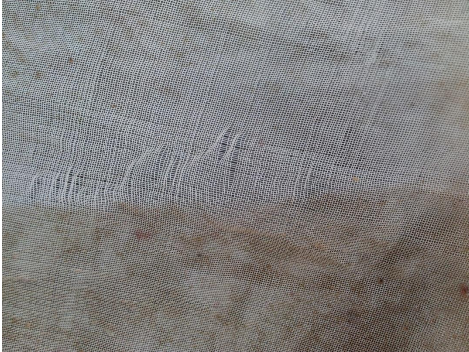
Figur 2: 10-metring med skader etter vaske ved 220 bar.
