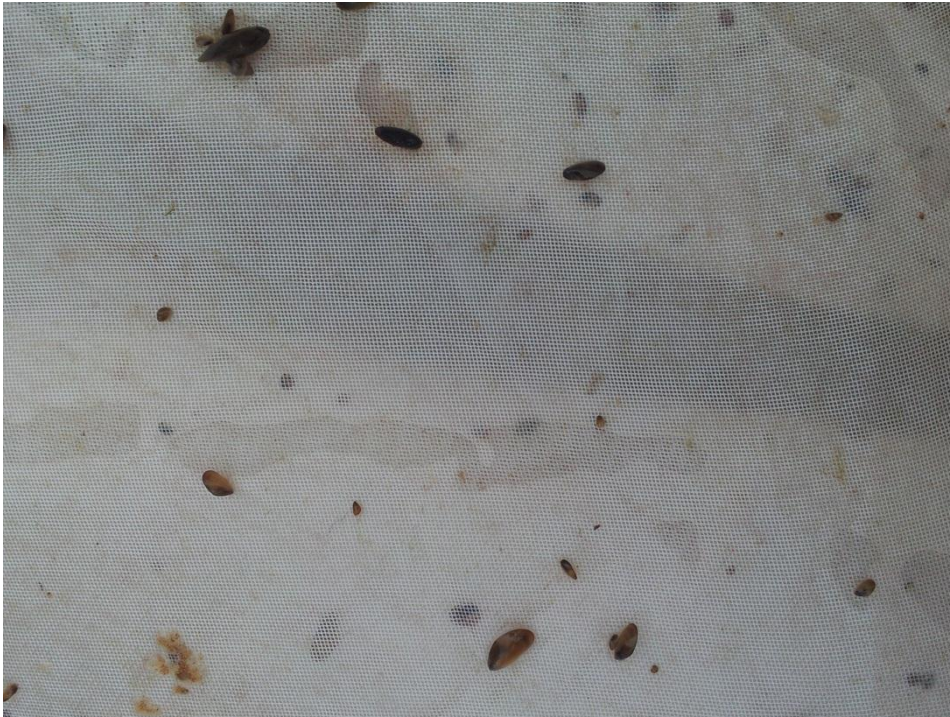
Figur 1: Etter vask av 6-meters luseskjørt med diskvasker ved 220 bar (28 l/min).
