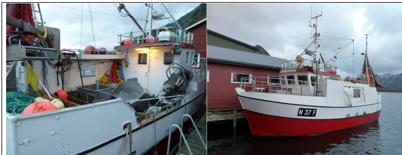
Bilde 10 Kystsjark 35 fot – type Finnvik aluminium - rigget for torskefiske med garn.
