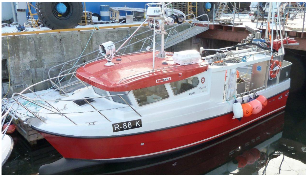
Bilde 16 Moderne Selfa 36 fots speedsjark rigget for kyst- og bankfiske med garn.
