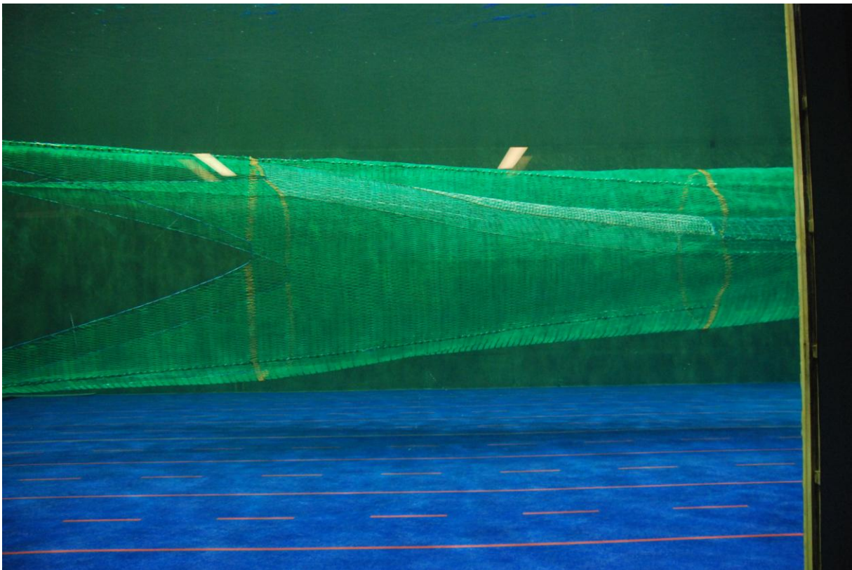
Bilde 3. Firepanels forpart med ledepanel, og fremste del av skillepanel. Merk oppoverrettet bue i sammenføyning ledepanel/skillepanel.
