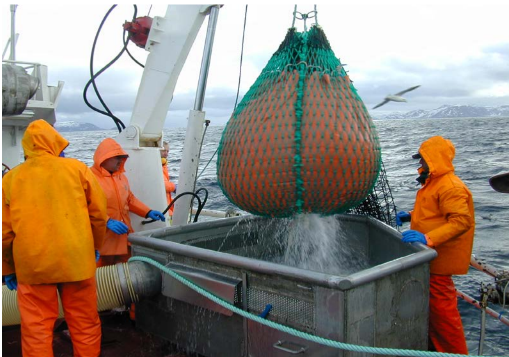
Bilde 1. Fisk løftes om bord i et sekkeløft med innmontert presenningssylinder. Fisken løftes ombord i vannbad.
