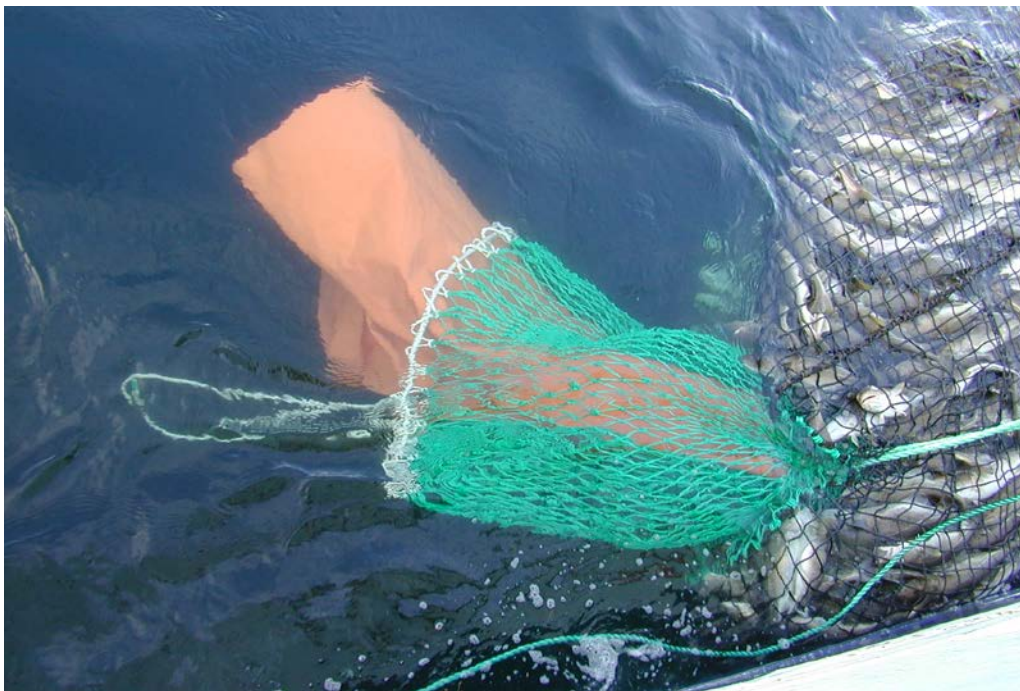
Bilde 2. Sekkeløftet i snurrevadposen er åpnet under fiske. Løftet er snørt sammen rett bak sammenføyning kvadratmaskepose – løft.
