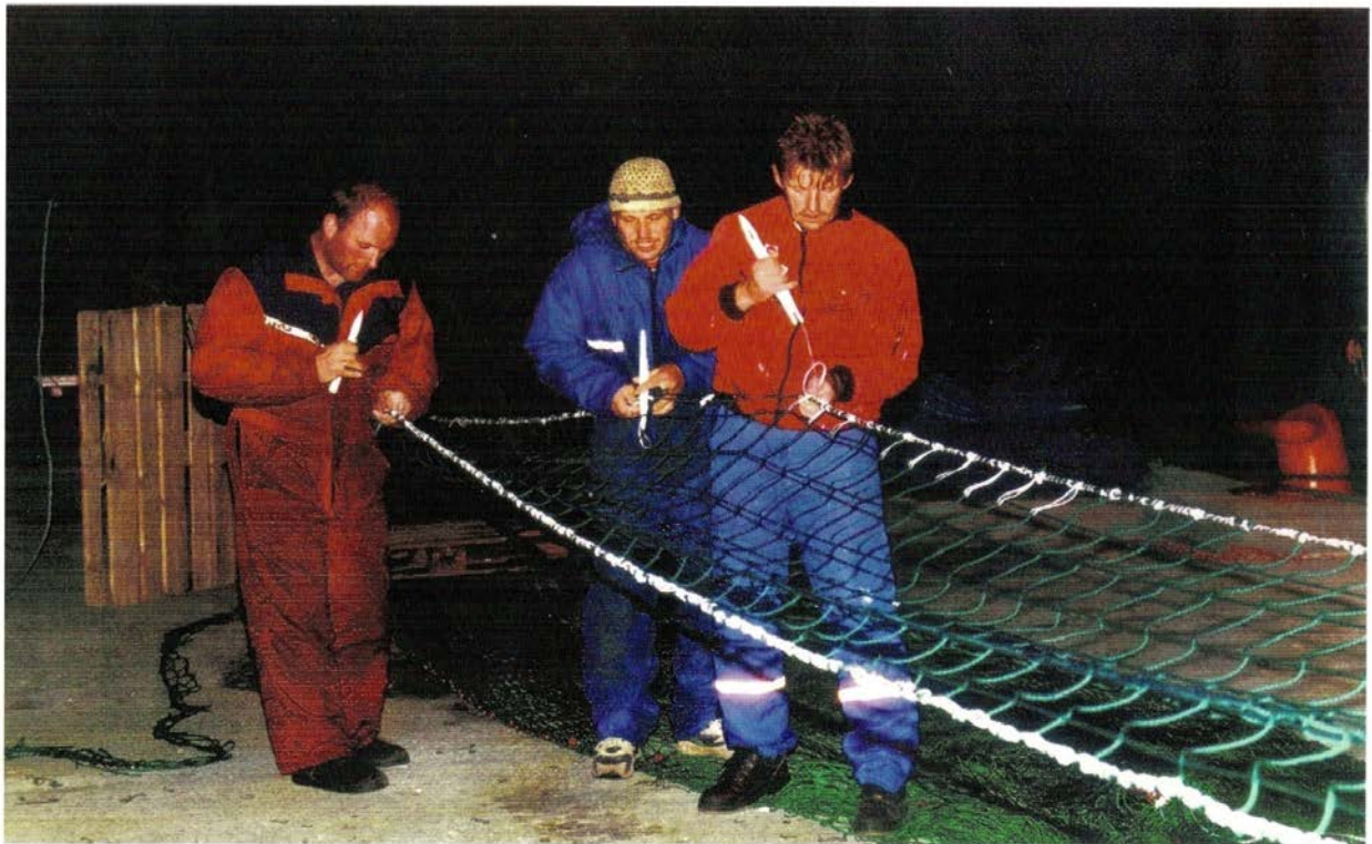
Bilde 2. Produksjon av horisontalt skillepanel til montering i forlengelse på snurrevad. Mannskap på M/S "Svein Frode", Svartneshamna, september 1998.
