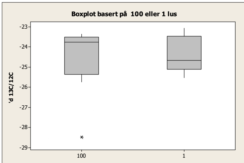
Figur 7. Boxplot av \delta^{13}\text{C} etter analyser av samleprøve på 100 copepoditter (N=6) og på enkeltcopepoditter (N=5). (Boxplottet viser max og min observert verdi, median, nedre og øvre kvartil, og *outlier)
