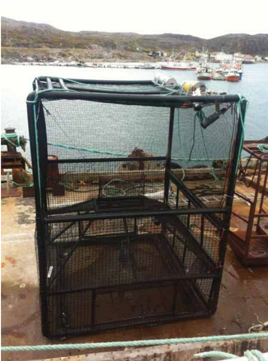
Figur 3. Teine bygget i plastrør påmontert videokameraer.
