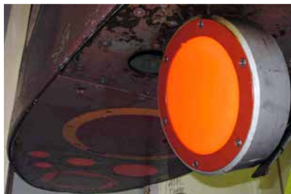
Figur 2: Sidemontert bredbåndssvinger, 170–270 kHz, under senkekjølen på "G.O. Sars".
