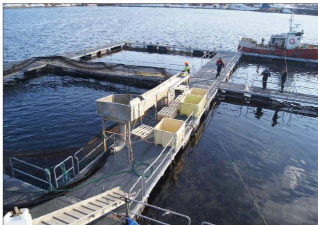
Bilde 49: Mottakssystemet er her plassert midt mellom mottaksmerkene. Fangster kan holdes fra hverandre eller fisk kan sorteres etter størrelse allerede ved mottaket.
