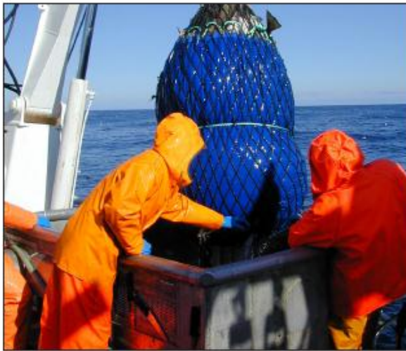
Bilde 23: Løftesekk med innmontert presseningsylinder. Magebånd montert midt på løfteposen for å begrense volum og vekt av fisk i pose.
