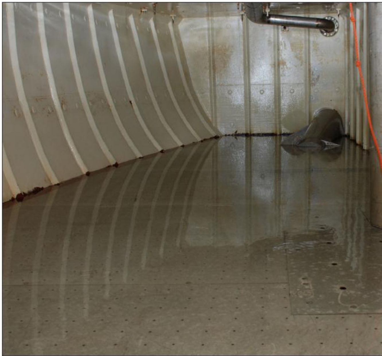
Bilde 39: Utforming av dobbelbunn om bord på M/S «KILDIN». Legg merke til lav perforering, hull for hver
