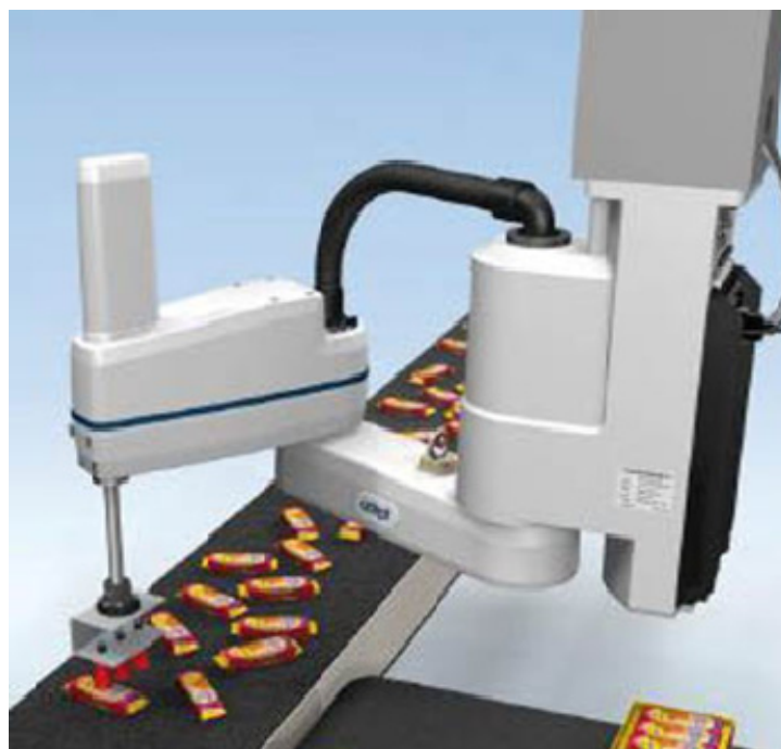
Figur 4. Scararobot med 4 frihetsgrader
