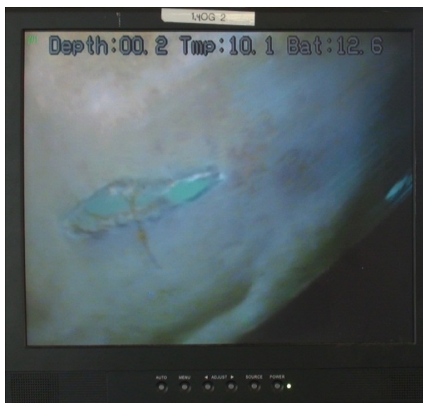
Figur 9 Skader på skjørtet kan slippe lus gjennom.
