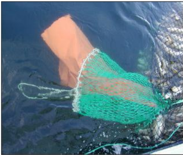
Bilde 22: Løftesekk med presseningsylinder. Løftesekken er åpen i bakkant, og snørt sammen rett foran ringene til løftestroppa.
