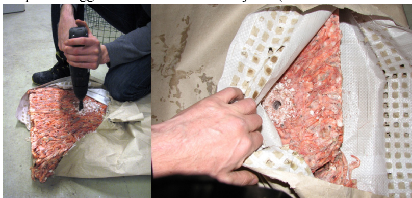
Figur 6. Innsetting av temperaturloggere for måling av kjernetemperatur ved tining og modning av industrireke.
