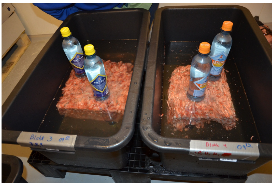
Figur 7. Tining og modning av industrireker i kjølerom.
