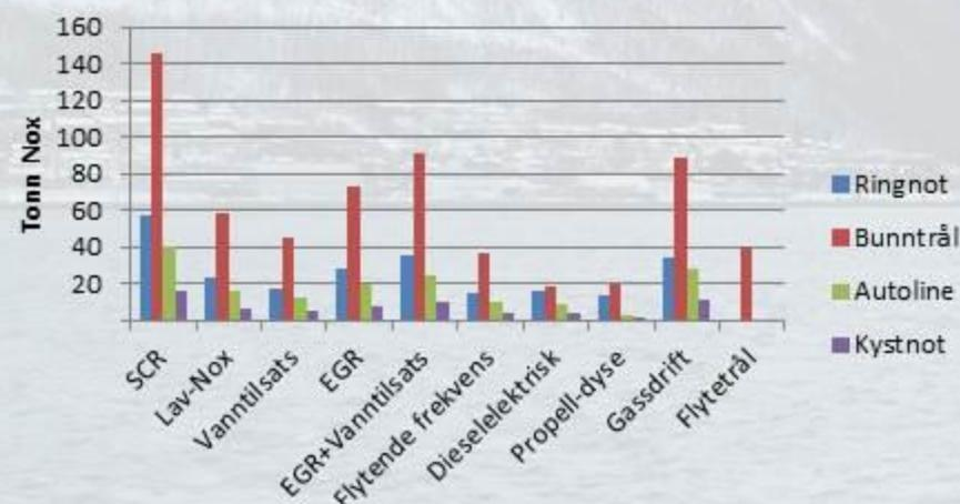
SCR-anlegg har høyest rensegrad, etterfulgt av EGR+vanntilsats, LNG-drift (gassdrift) og EGR. Felles for disse er at de er plasskrevende. I fartøy der det ikke er plass til store installasjoner kan Lav-nox-ombygging, flytende frekvens eller propell/dyse-tiltak vurderes.
