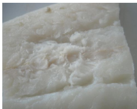
Figur 4-5: Overflateskade etter behandling
