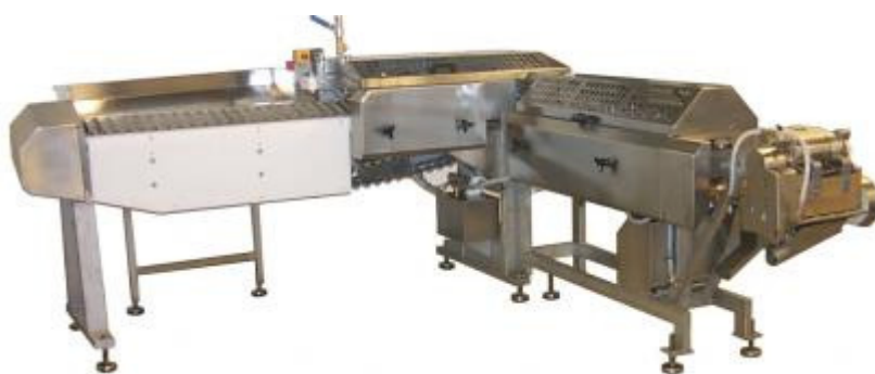
Figur 3-2: Arencos VMK 16 og 11 fileteringsmaskin
