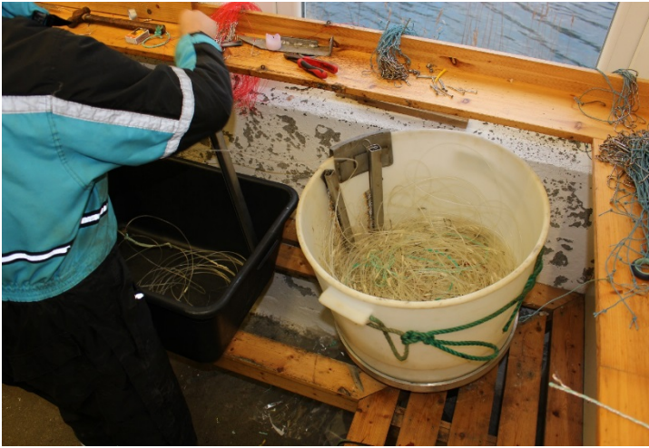
Bilde 3. Spesialdesignede magasin for å letter kunne ta snurr av lina.
