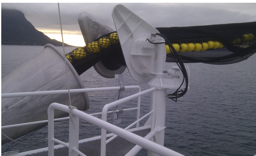
Figur 3: Antennene ble installert ved utløpet av notrøret.
